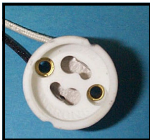
Douille halogène 130 volts Base GU10 FIL amiante 24" Max 200°C Commande :SC-188-24 Pas de fil Max 200°C Commande :05039
