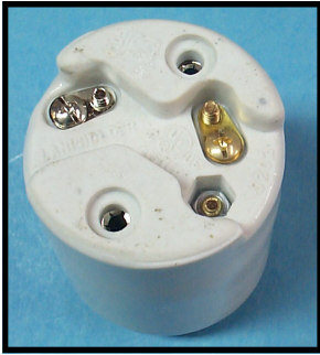
Douille porcelaine Culot moggle 4kv 1500w-600v Borne à vis Avec nut captive 8/32 Commande :08694/400
